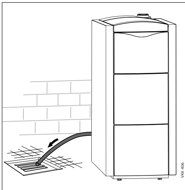
Rys. 4.6 Montaż odprowadzenia wody kondensacyjnej
