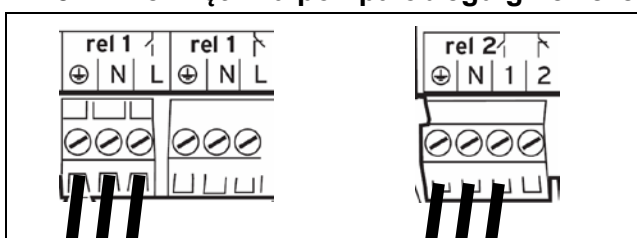
Przyłączenie zewnętrznej pompy obiegu grzewczego
